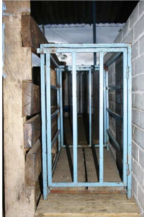
Cajón de pesaje sobre los rieles detectores de peso en Kg.
