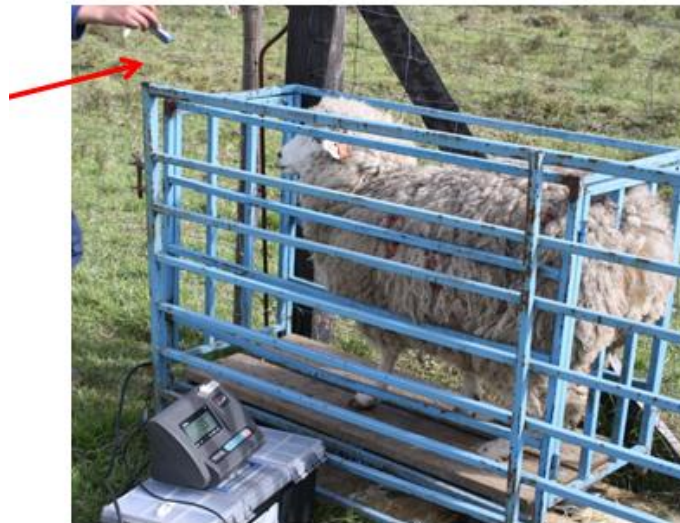
Apertura de cajón de pesaje para salida del individuo
